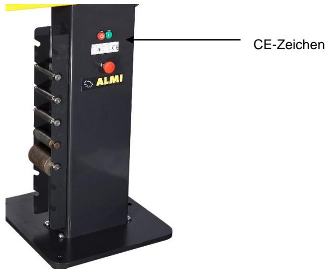
**Abbildung 2.3-2: Befestigungsstelle des Typenschildes**
