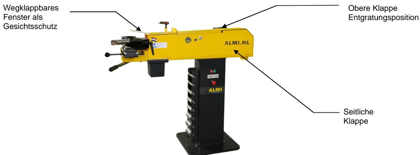
Abbildung 3.1-1: Sicherheitsvorrichtungen
