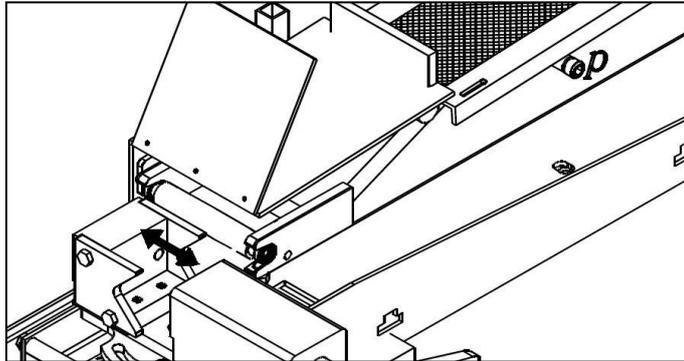
**Abbildung 4.6-6: Einstellen der Schleifrolle bei schief laufendem Schleifband**
