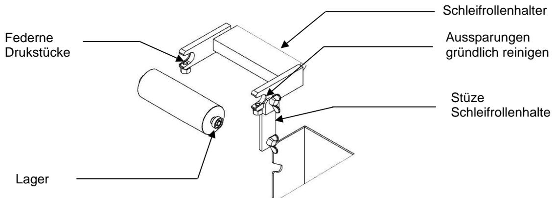
**Abbildung 4.6-4: Auswechseln der Schleifrolle**
