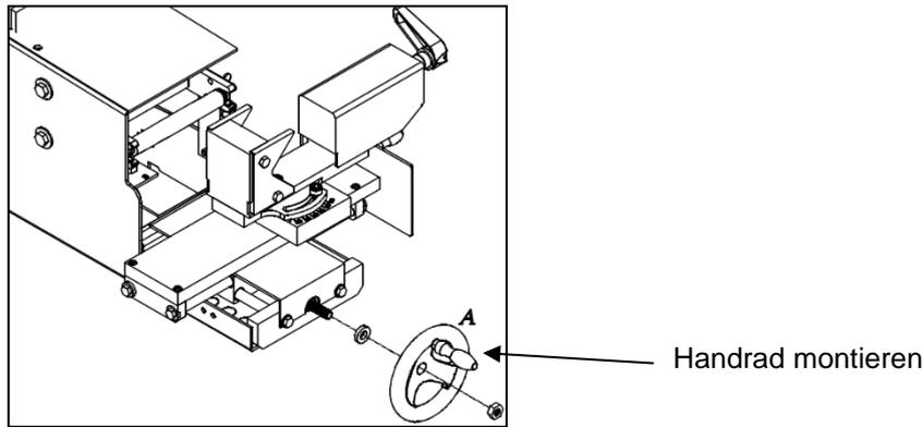
**Abbildung 5.2-3: Montage von Handrad und Hebel**
