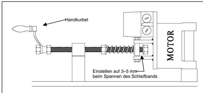
**Abbildung 4.6-3: Bandspannvorrichtung**
