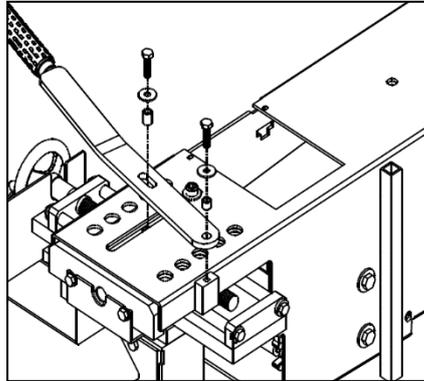
Abbildung 4.6-8: Hebel montieren
