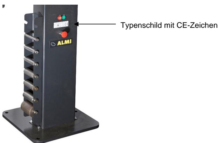
**Abbildung 2.3-2: Befestigungsstelle des Typenschildes**
