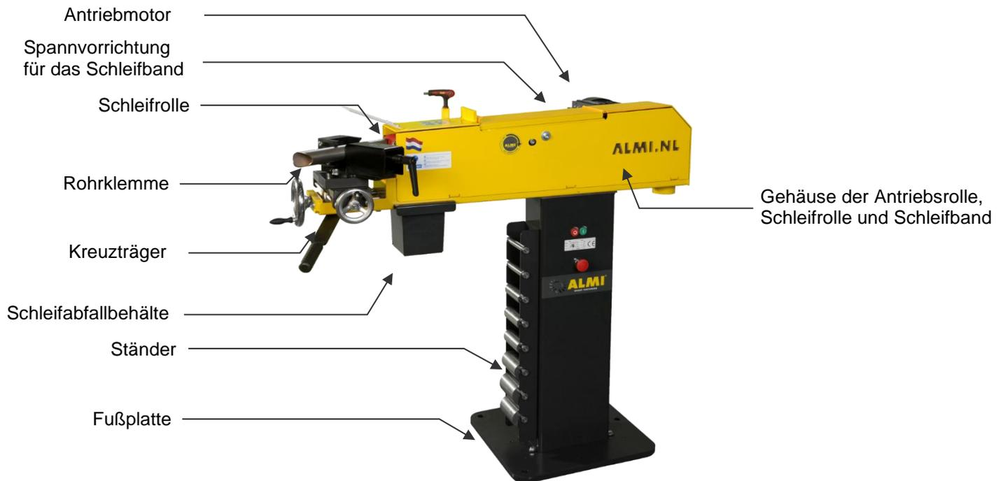
**Abbildung 4.2-1: Aufbau der Maschine**
