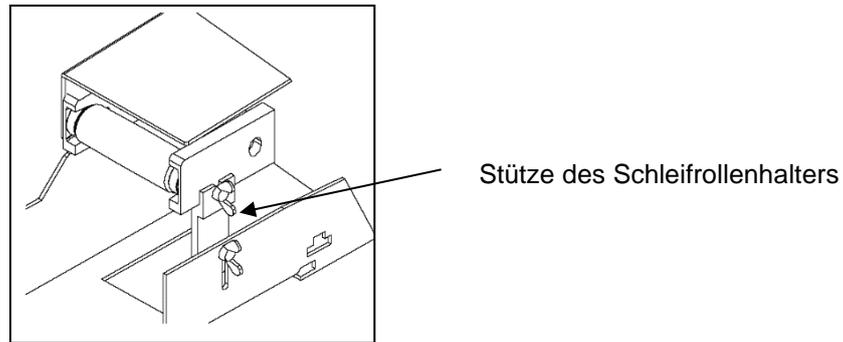
**Abbildung 4.6-2: Stütze des Schleifrollenhalters**
