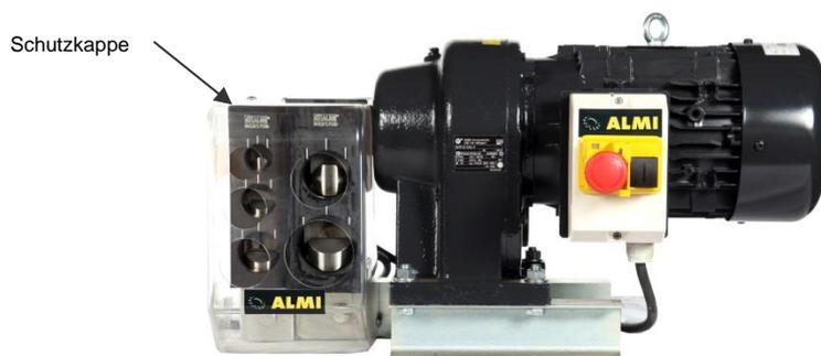
**Abbildung 3.1-1: Sicherheitsvorrichtungen**
