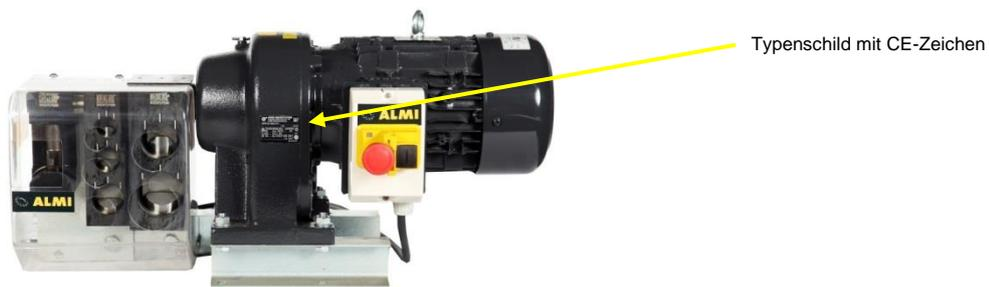
**Abbildung 2.3-2: Befestigungsstelle des Typenschilds**
