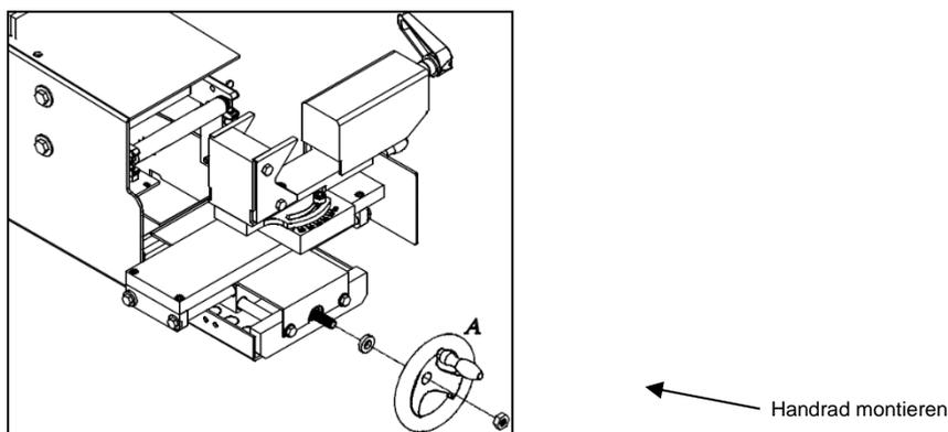
**Abbildung 5.2-3: Montage von Handrad und Hebel**
