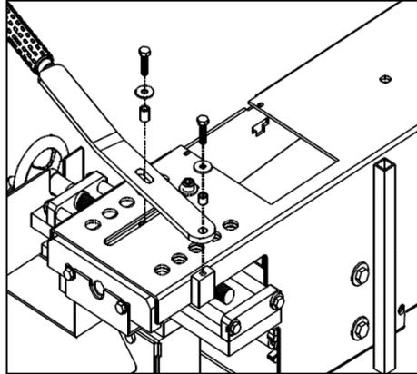
**Abbildung 4.6-8: Hebel montieren**
