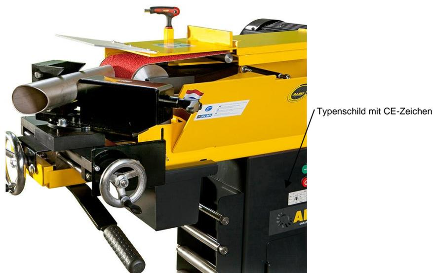
**Abbildung 2.3-2: Befestigungsstelle des Typenschildes**
