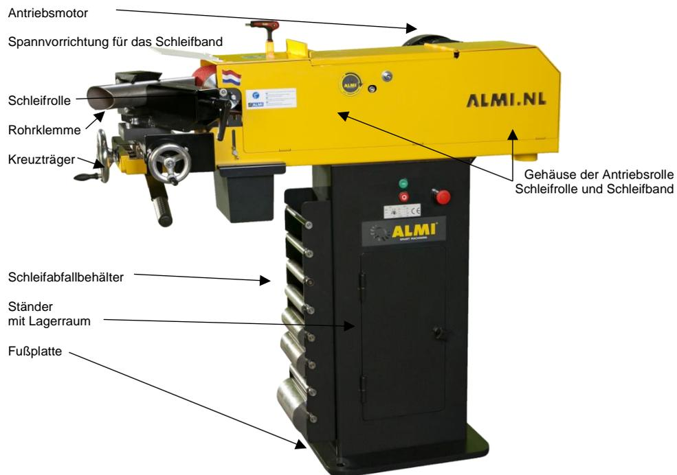
**Abbildung 4.2-1: Aufbau der Maschine**
