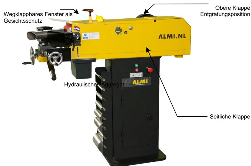
**Abbildung 3.1-1: Sicherheitsvorrichtungen**
