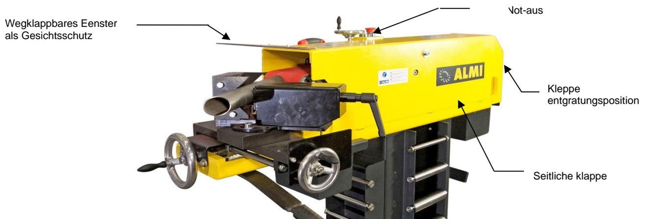
**Abbildung 3.1-1: Sicherheitsvorrichtungen**
