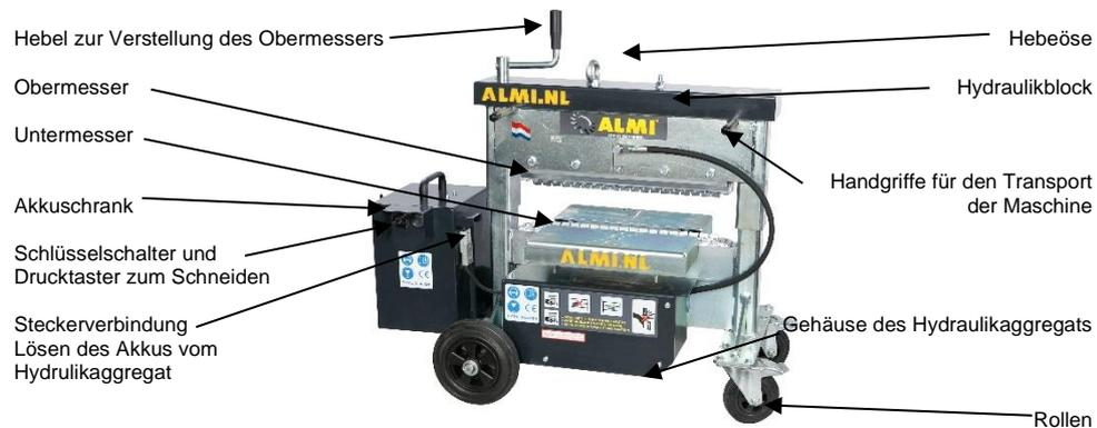
**Abbildung 4.2-1: Aufbau der Maschine**
