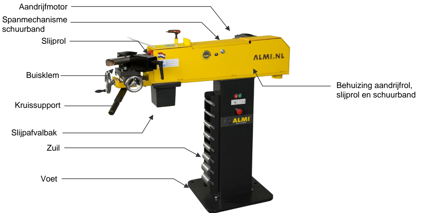
Figuur 4.2-1: Opbouw van de machine
