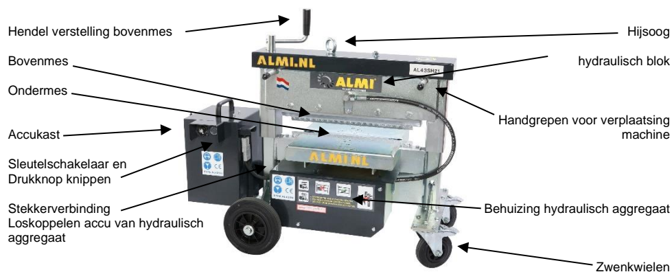
Figuur 4.2-1: Opbouw van de machine
